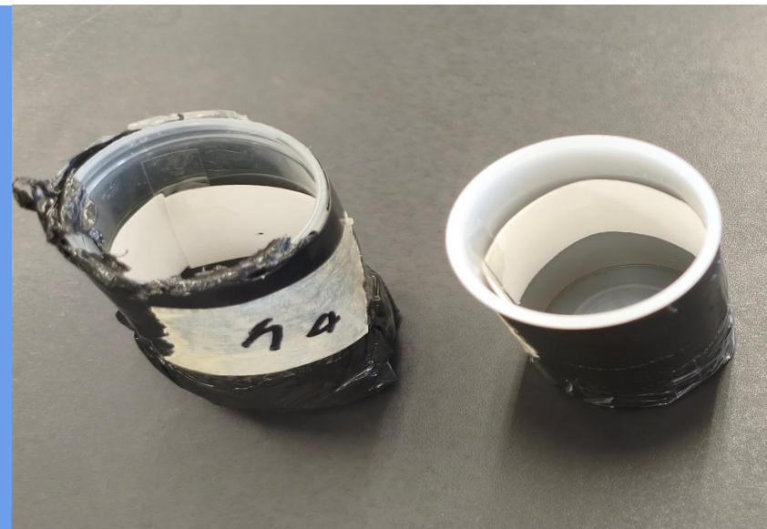
左…グリセリン2%KIパッシブサンプラー 右…グリセリン0.5%パッシブサンプラー
