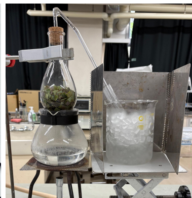
↑水蒸気蒸留の様子と簡易図
