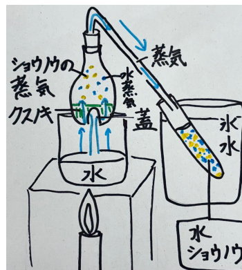
↑水蒸気蒸留の様子と簡易図
