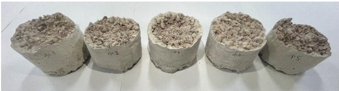
図2 軽石小を用いた防音壁
