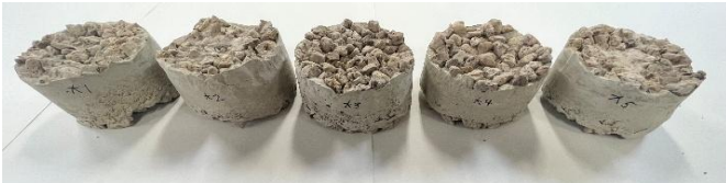
図1 軽石大を用いた防音壁
