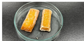
図5.100℃で加熱したものの表面が褐色に変化している
