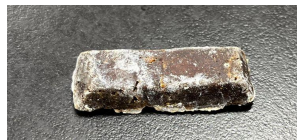
図6.120℃で加熱したものの100℃で加熱したものに比べさらに褐色に変化している
