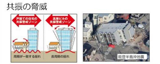
**共振** = 建物固有の振動周期と地震の周期が一致した時に激しく揺れて倒壊につながる。
