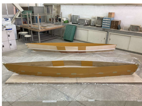
⑤外型枠と内型枠の完成
