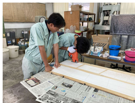
③船体板の切り出し
