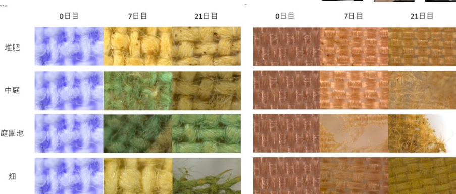
図2. デジタルマイクロスコープで観察した綿布(左)とキュプラ(右)の時間経過による分解の様子
