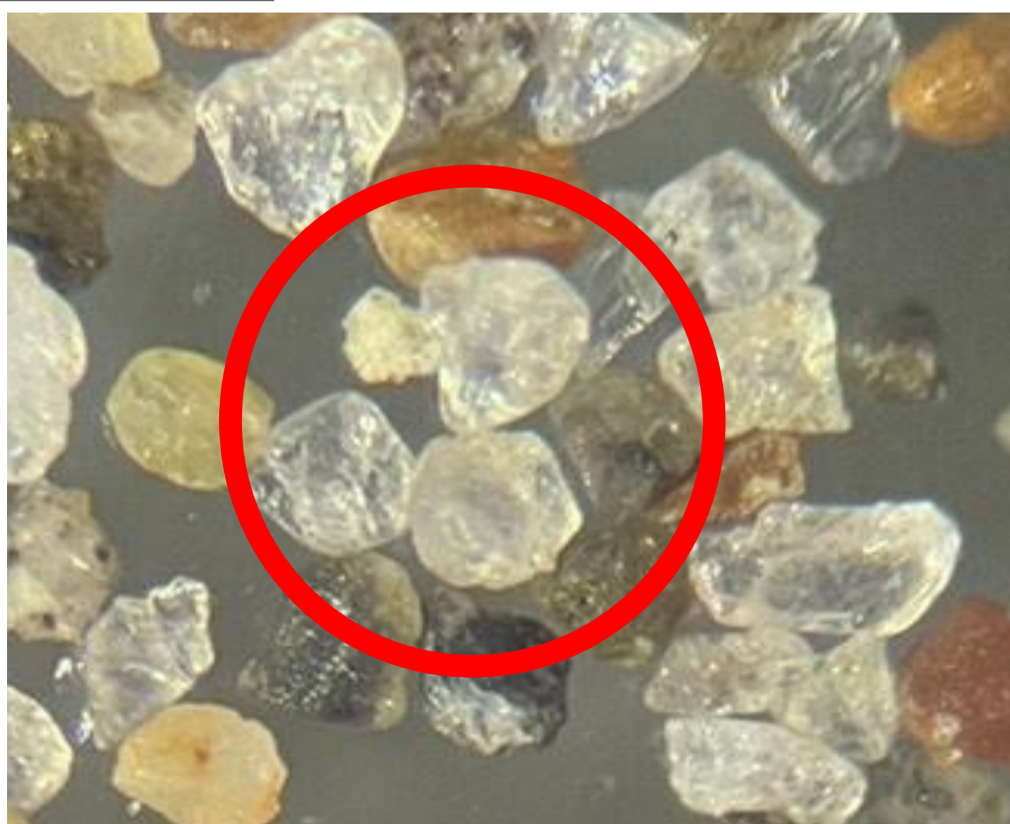
図3. 顕微鏡で観察できた、球に近い高温型石英
