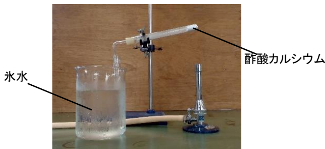
図1. 酢酸カルシウムの乾留実験の様子
