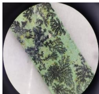
Fig.3 銅めっき後のMg金属表面(倍率20倍)
